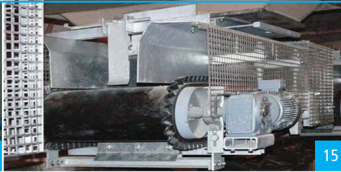
Bild 14: Luftstoßgerät als Siloaustrags-hilfe für schwerfließende Materialien. Bild 15: Dosierband zur volumetrischen oder gravimetrischen Dosierung der Zuschläge. Bild 16, 17: Dosiersegmentverschlüsse in verschiedenen Ausführungen. Bild 18: Wiegeband mit Verteilung für 2 Aufzugskübel. Bild 19: Verfahrbare Zuschlagstoffwaage im Fertigteilwerk. Bild 20: Behälterwaage für Zuschläge. Bild 21: Zweiklappen-Freiflussverschluss zur Zuschlagstoffwaage. Bild 22: Zwei-Wege-Verteilerverschluss zur Zuschlagstoffwaage für Beschickung von 2 Mixern. Bild 23, 24: Materialbeschicker in Bodenentleer- oder Kippkübelausführung.
